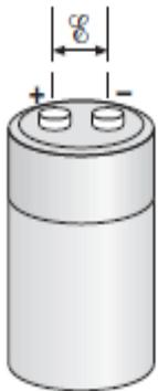
La diferencia de potencial entre las terminales de una batería cuando no está conectada a un circuito se llama fuerza electromotriz (fem) de la batería y se designa con el símbolo  $\varepsilon$  y su unidad es el volt.
